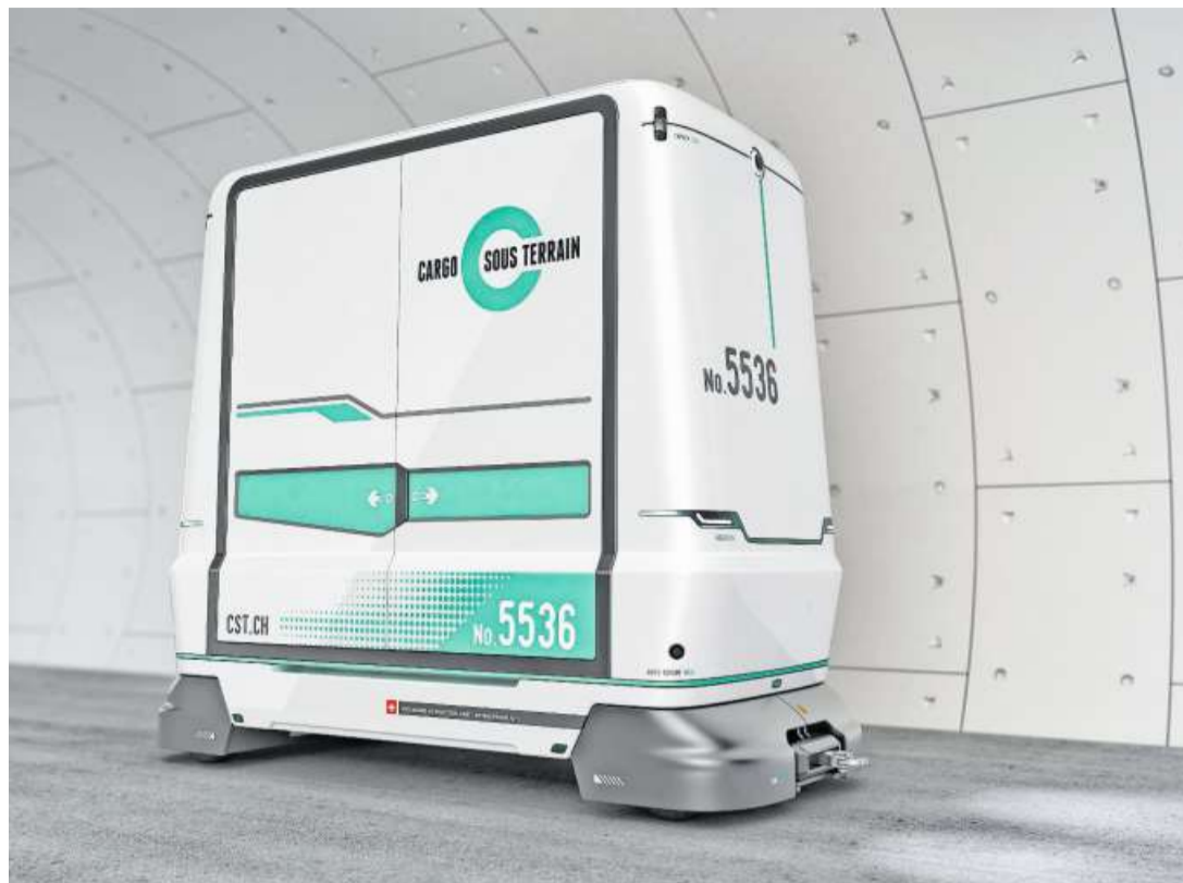
Mit 30 Kilometer pro Stunde sollen Güter vollautomatisch unter der Schweiz hindurchfahren.
